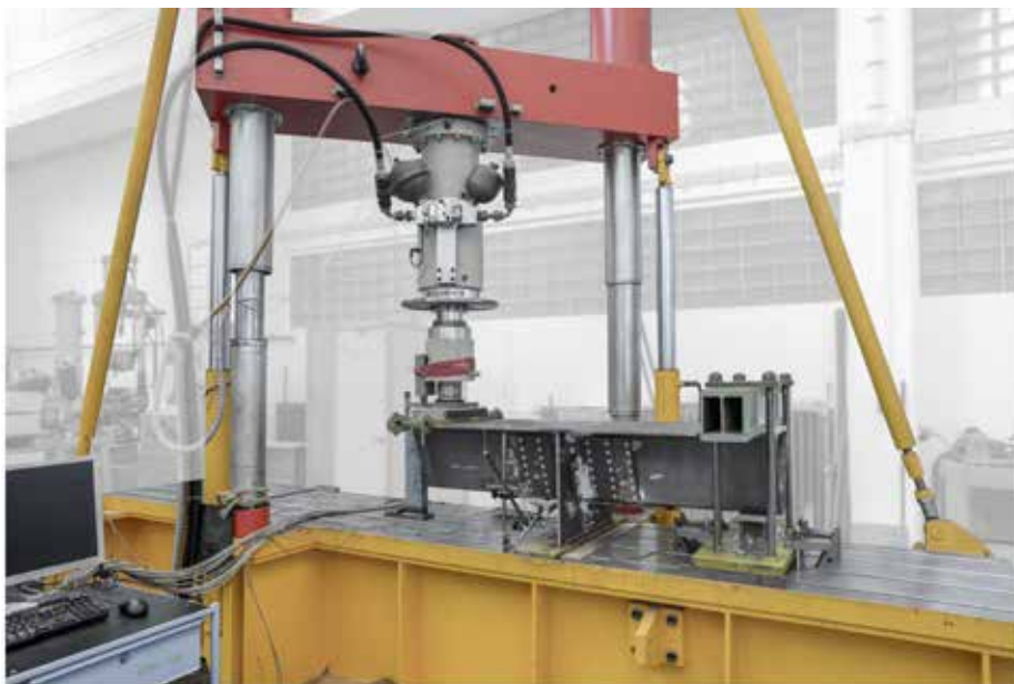
Bild 1: Ansicht des Versuchsaufbaus der Ermüdungsversuche an Längsrippen-Querträger-Anschlüsse an der Universität Stuttgart
