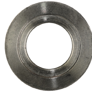
Abbildung 3: Exemplarische Probenoberfläche nach kontinuierlichem Druckversuch für eine Ringprobe
