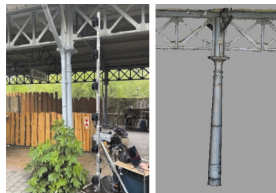
Abbildung 1: Photogrammetrische Aufnahme der Bahnhofstütze mit einem höhenflexiblen Stativ (links) und abgeleitete Punktwolke (rechts).
