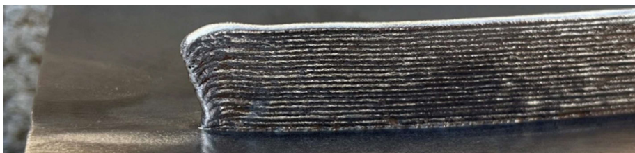
Abbildung 2: Beispiel für eine Schweißnaht mit 20 Lagen
