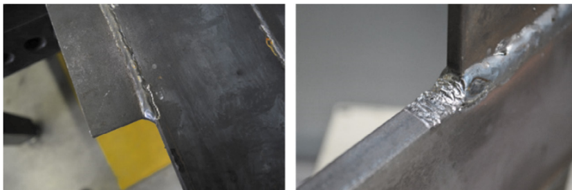
Abbildung 2: HFH-Nachbehandlung am seitlichen Knotenblech – links) einfache Hammerspur: PK 1-3, rechts) großflächige Nachbehandlung: PK 4-6
